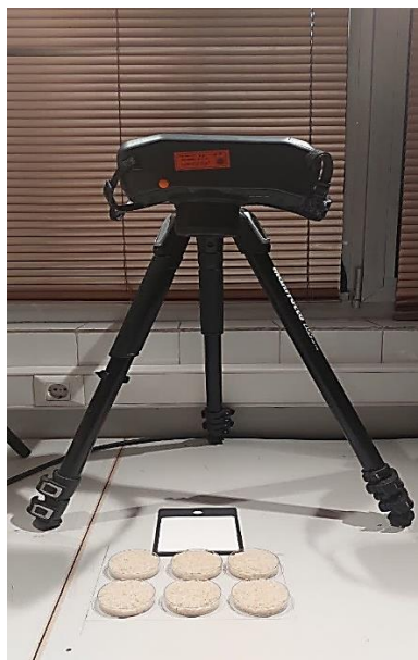
شکل ۱. تصویری از دوربین ابرطیفی همراه با نمونه‌های برنج و صفحه کالیبراسیون که یک مرتبه در ابتدای داده برداری نیاز است
