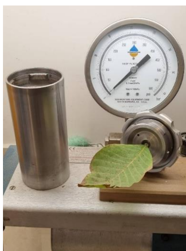
شکل ۵. نحوه قرار گیری برگ در دستگاه اندازه‌گیری پتانسیل آب برگ
