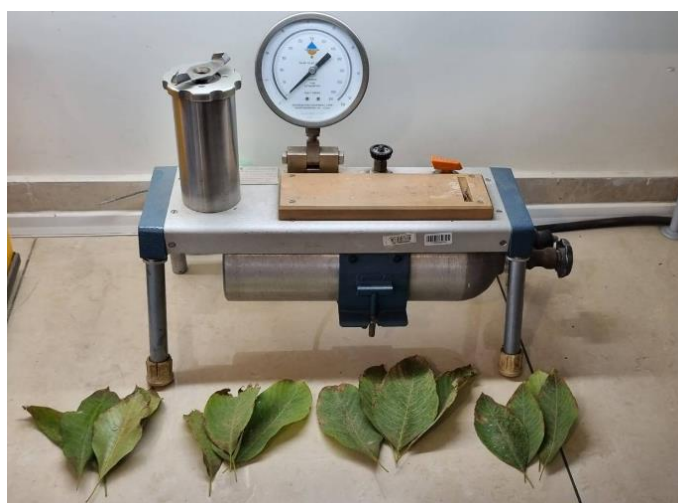
شکل ۵. نحوه قرار گیری برگ در دستگاه اندازه‌گیری پتانسیل آب برگ
