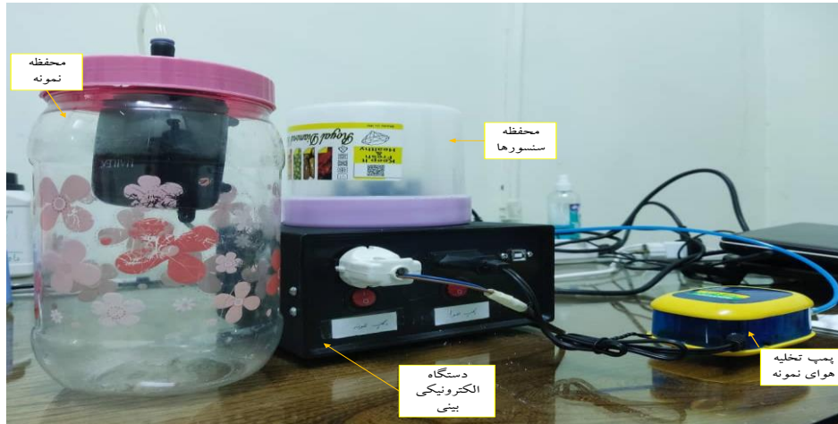
شکل ۸- سامانه ماشین بویایی بی سیم با قابلیت انتقال اطلاعات از راه دور
