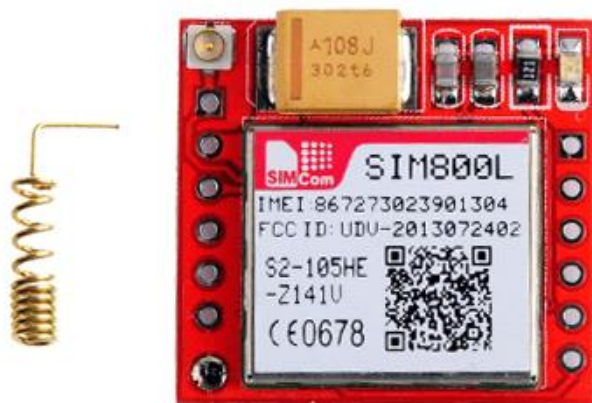
شکل ۲- شکل ظاهری ماژول GSM800L
