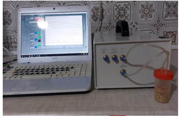
شکل ۱. نمای کلی و شماتیک سامانه بینی الکترونیک در هنگام آزمایش
