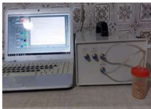
شکل ۱. نمای کلی و شماتیک سامانه بینی الکترونیک در هنگام آزمایش
