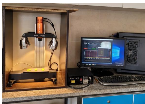
شکل ۳. عکس‌برداری از برگ‌های گیاه گوجه‌فرنگی با دوربین فراطیفی (Hyspim HSI-Vis_Nir-15fps، سوئد)
