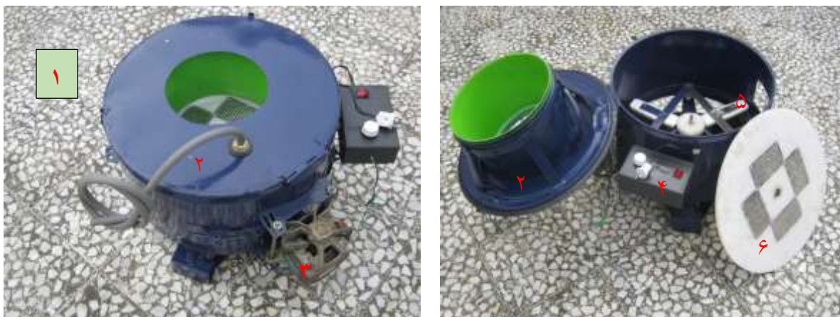
شکل ۲. ۱- دستگاه پوست‌گیر نارنج، ۲- درب و مکانیزم شستشو، ۳- موتور انتقال قدرت ۴- سامانه کنترلی ۵- فرچه‌های تمیزکننده مخزن ۶- صفحه دورانی تیغه‌ها (تفلون سفید با تیغه‌ها)
