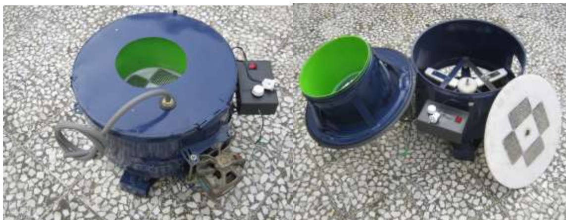
شکل ۲. ۱- دستگاه پوست گیر نارنج، ۲- موتور انتقال قدرت ۳- سامانه کنترلی (چپ) ۴- درب و مکانیزم شستشو، ۵- فرچه های تمیز کننده مخزن ۶- صفحه دورانی تیغه ها (تفلون سفید با تیغه ها) (راست)
