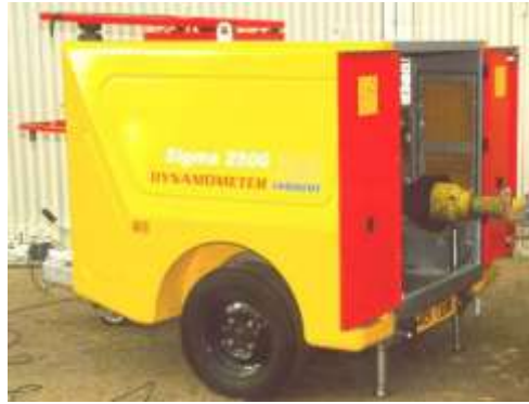
شکل ۱. دینامومتر مدل NJ-FROMENT Σ5
