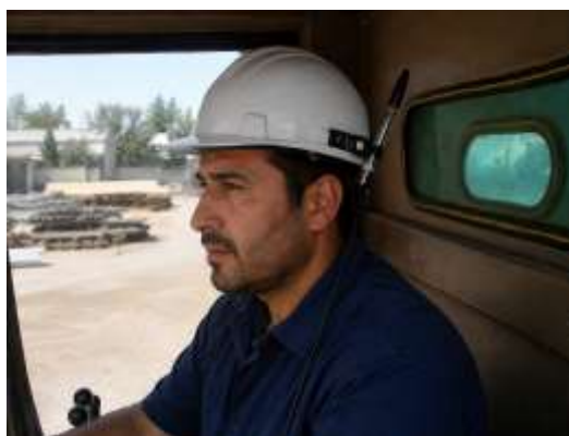
شکل ۲. میکروفن اندازه‌گیری در موقعیت گوش اپراتور
