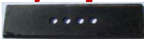
شکل ۱. طرح تیغه‌های برش کنونی ماشین برداشت نیشکر
