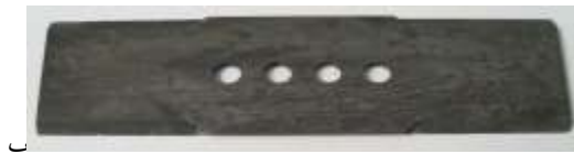
شکل ۲. (الف) ناحیه شکست تیغه‌های مرسوم و (ب) طرح تیغه تقویت شده
