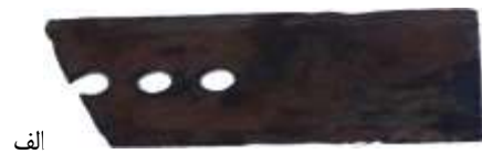
شکل ۲. (الف) ناحیه شکست تیغه‌های مرسوم و (ب) طرح تیغه تقویت شده
