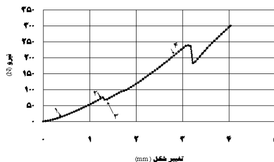
شکل ۶- نمودار نیرو- تغییر شکل بارگذاری بر روی نصف نمونه میوه سیب با استفاده از دستگاه تست یونیورسال
