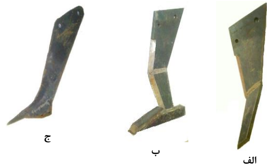
شکل ۱- الف تیغه کج ساق، ب- تیغه پاراپلو، ج- تیغه مرسوم
