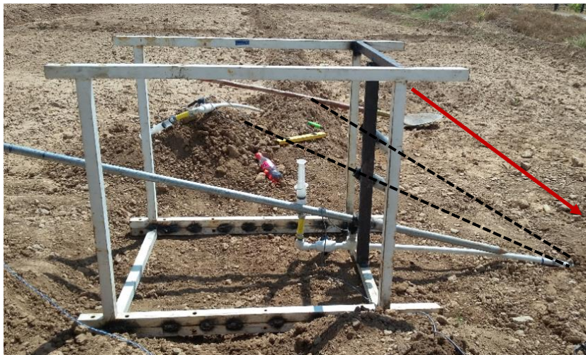
شکل ۵- شاسی فلزی سوراخ زنی و نصب حسگرهای بولینگ
