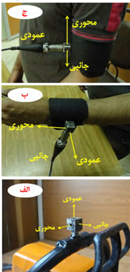
شکل ۱- موقعیت و جهت نصب حسگر بر روی دسته اژه موتوری (الف)، مچ دست (ب) و بازوی کاربر (ج)
