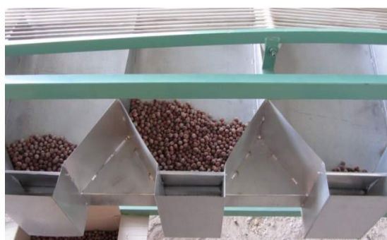
شکل ۳. تصویر فندق‌های اندازه‌بندی شده توسط دستگاه ساخته شده.
