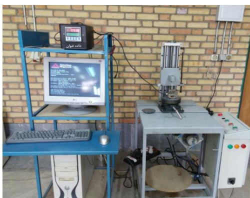
شکل ۴- دستگاه تست مواد بیولوژیک مورد استفاده جهت تعیین خواص مکانیکی محصولات بیولوژیکی (Ghayiebi et al. , 2009)
