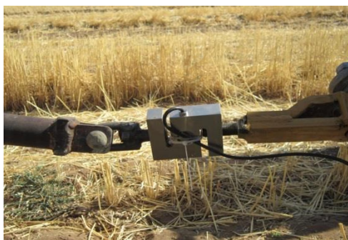
شکل ۱. الف نصب بارسنج بین دو تراکتور
