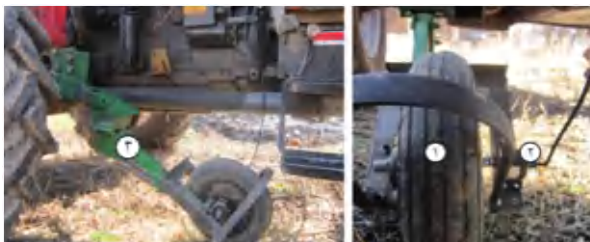
شکل ۵-الف- چرخ پنجم مورد استفاده در این تحقیق و محل قرارگیری آن ۱. چرخ پنجم، ۲. شفت انکودر و ۳. شاسی و اتصالات چرخ پنجم
