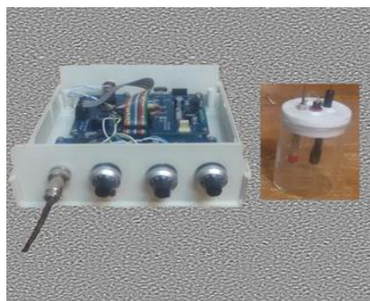
شکل ۱. سامانه زبان الکترونیک، (الف) نمای شماتیک، (ب) نمای واقعی.
