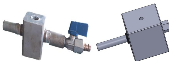
شکل ۳. نمایی از ونتوری طراحی شده (الف) ساخته شده (ب) و اجزای متصل به آن
