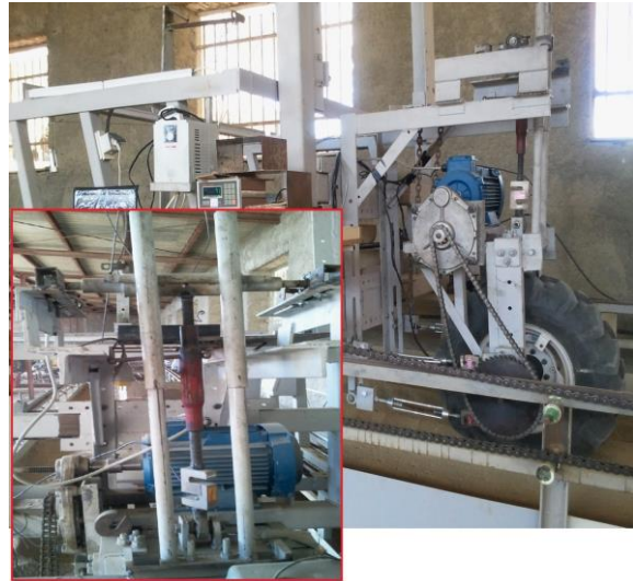
شکل ۲. لودسل ها و مجموعه داده برداری و نحوه عبور چرخ از روی مانع و اجزای آزمونگر تک چرخ
