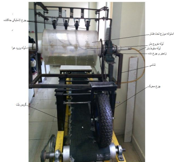
شکل ۱. موزع استوانه‌ای تحت فشار مجهز به جداکننده مکانیکی بذر (چرخ لاستیکی جداکننده)
