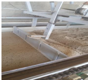
شکل ۲. فرآوری خاک انباره خاک پیش از آزمایشات (چنگه، لولر و غلتک)
