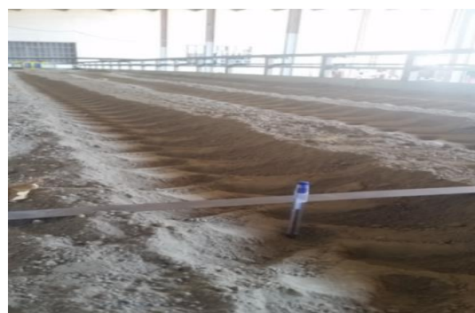
شکل ۳. تکرار عبور چرخ در مسیرهای معین مربوط به هر کرت و مجموعه آزمونگر چرخ و سیستم تحویل داده
