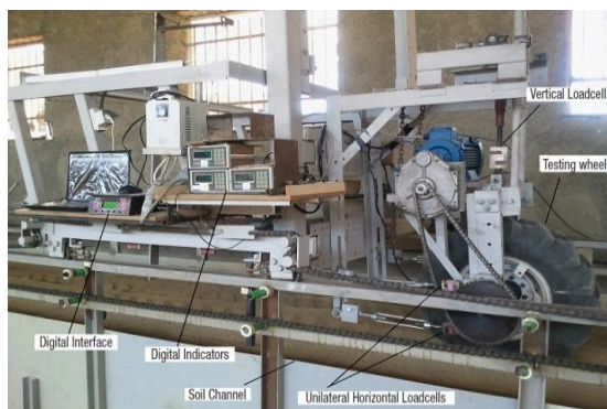
شکل ۳. تکرار عبور چرخ در مسیرهای معین مربوط به هر کرت و مجموعه آزمونگر چرخ و سیستم تحویل داده
