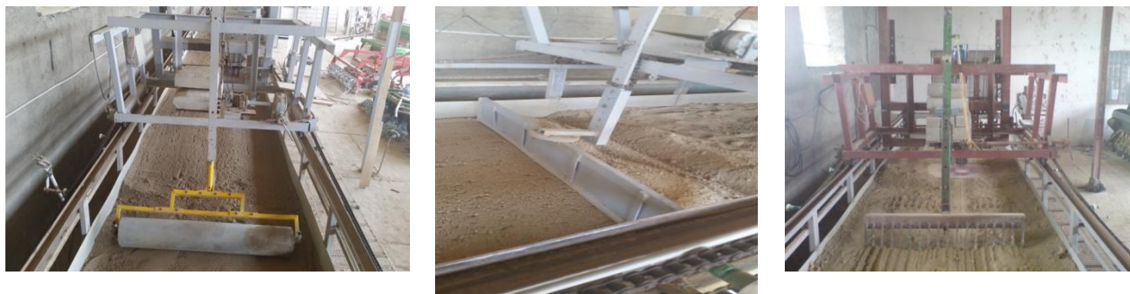
شکل ۲. فرآوری خاک انباره خاک پیش از آزمایشات (چنگه، لولر و غلتک)
