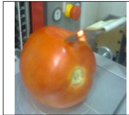
شکل ۲. پوست گیری میوه از محل علامت گذاری شده (الف) و آزمون پنچری با دستگاه تست محوری (ب)
