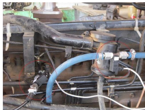
شکل ۶. محل نصب دبی‌سنج‌های توربینی بر روی موتور تراکتور
