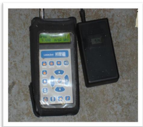
شکل ۳- ارتعاش سنج پاسخ انسانی مدل (HVM100) و نصب مبدل جهت اندازه گیری ارتعاش در جهت های x، y و z
