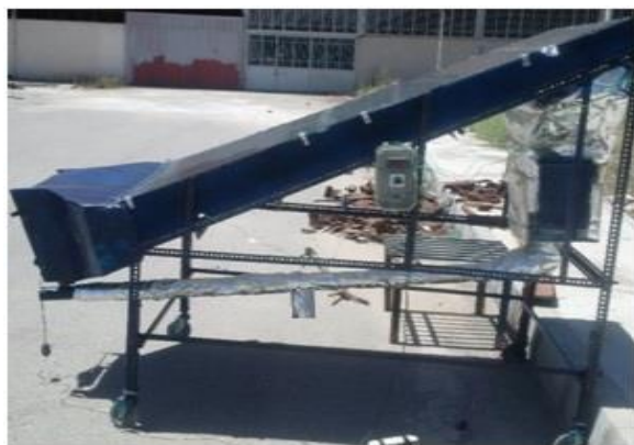
شکل ۱. خشک‌کن خورشیدی شامل: (۱) صفحه جمع کننده، (۲) شیشه، (۳) سوراخ‌ها، (۴) دیواره عایق بندی شده، (۵) کانال، (۶) شاسی، (۷) کابینت، (۸) کنترلر فن، (۹) کنترلر دما، (۱۰) لوله انتقال، (۱۱) کانال ورودی، (۱۲) مبدل، (۱۳) دریچه خروجی اول، (۱۴) دریچه خروجی دوم
