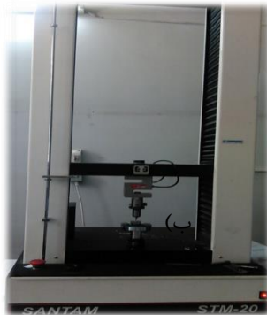
شکل ۱. الف) طرح‌واره فک استفاده شده در آزمون سه نقطه‌ای (خمشی) ب) تصویر دستگاه اینستران
