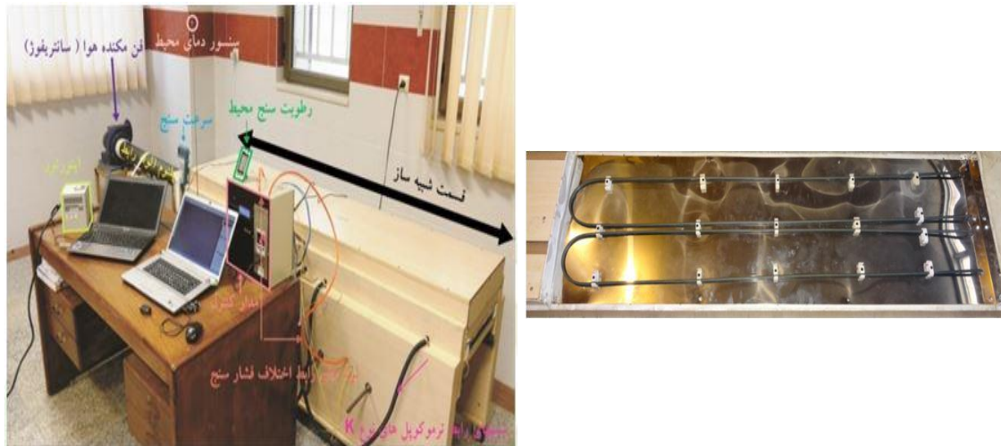
شکل ۱. تصویر کلکتور خورشیدی صفحه تخت به همراه المنت حرارتی به کار گرفته شده
