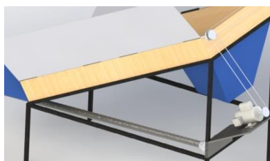
شکل ۲. حسگر، مدار فرمان و موتور الکتریکی استفاده شده در سامانه برای منعکس کننده‌های خورشیدی
