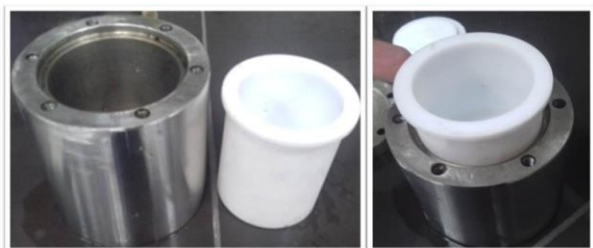
شکل ۱. اتوکلاو هیدروترمال (شامل دو محفظه استوانه ای)
