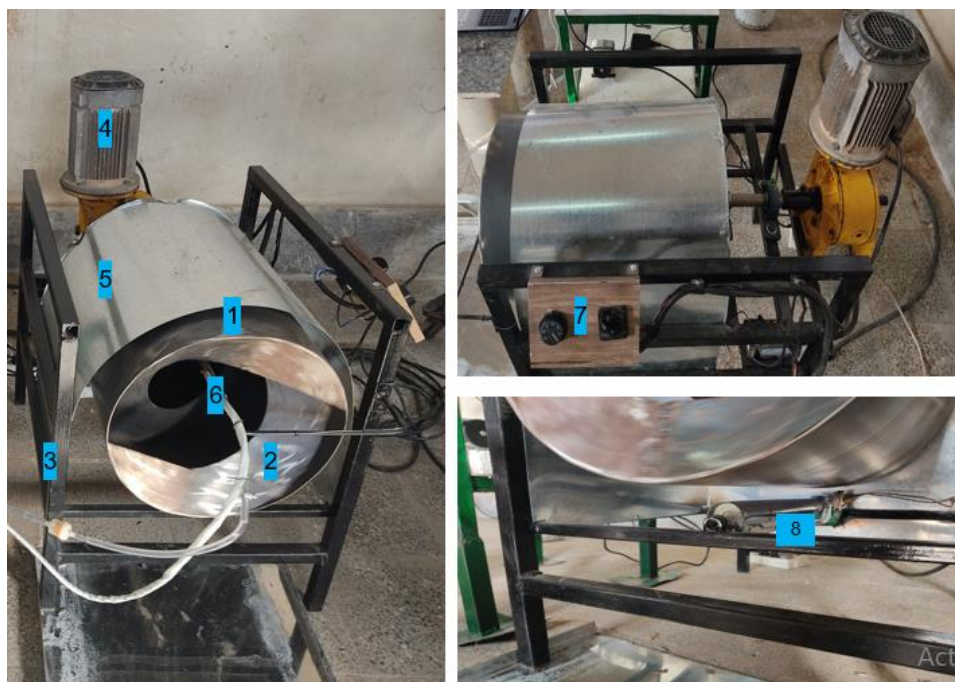
شکل ۱. دستگاه برشته‌کن ساخته شده، تابه استوانه‌ای (۱)، پره‌های مارپیچی (۲)، شاسی (۳)، الکتروموتور و جعبه‌دنده کرمی (حلزونی) (۴)، پوشش گالوانیزه (۵)، ترموکوپل (۶)، تابلو کنترل (۷) و مشعل خطی (۸)
