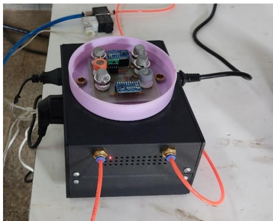
شکل ۲. دستگاه بینی الکترونیک مورد استفاده در تحقیق
