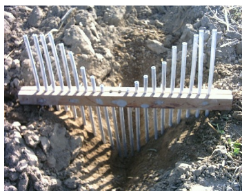
شکل ۴- نحوه اندازه گیری سطح مقطع شیار با استفاده از پروفیل متر عرضی
