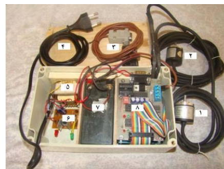
1- چرخش سنج چرخ ستاره‌ای 2- چرخش سنج چرخ پنجم 3- درگاه سریال RS 232 4- ورودی برق به شارژر 5- ترانسفورماتور کاهنده 6- مبدل جریان متناوب به مستقیم 7- باتری 8- صفحه شیکه کننده داده‌ها
