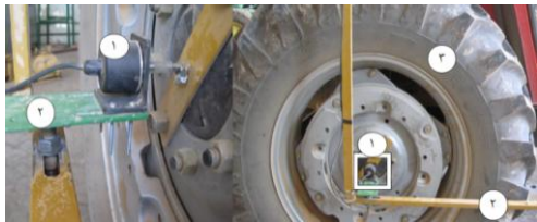
شکل ۳- ب. چرخ محرک عقب و شفت انکودر متصل به آن: ۱. شفت انکودر، ۲. شاسی و اتصالات، و ۳. چرخ محرک عقب
