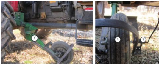
شکل ۳- الف. چرخ پنجم استفاده شده در تحقیق و محل قرارگیری آن ۱. چرخ پنجم، ۲. شفت انکودر، و ۳. شاسی و اتصالات چرخ پنجم
