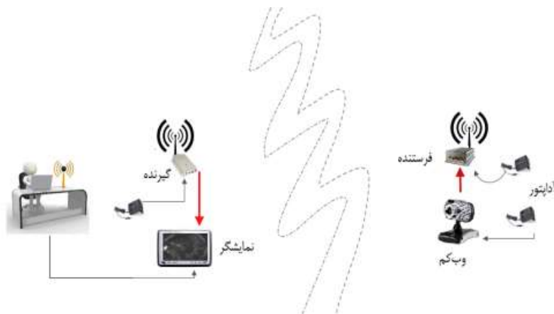
شکل ۱. سیستم اخذ تصویر و انتقال آن به صورت بی‌سیم
