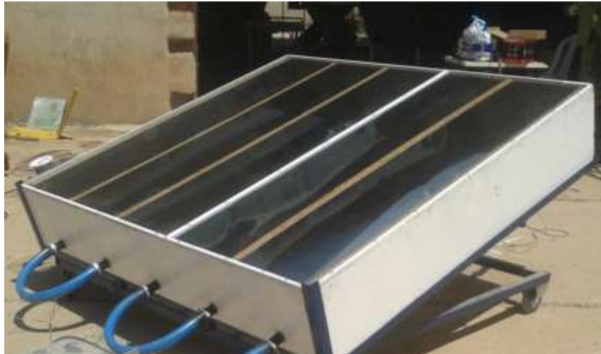
شکل ۲. تصویر کلکتور CPC ساخته شده و مورد آزمایش
