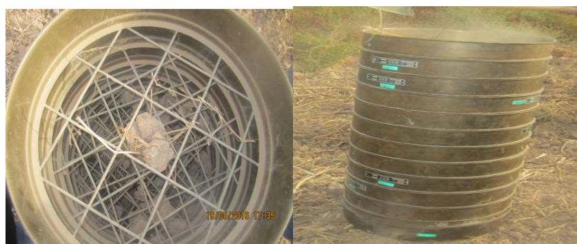
شکل ۴. سرندهای مطابق (راست)، نمای از بالا، سرندهای مطابق (چپ)
