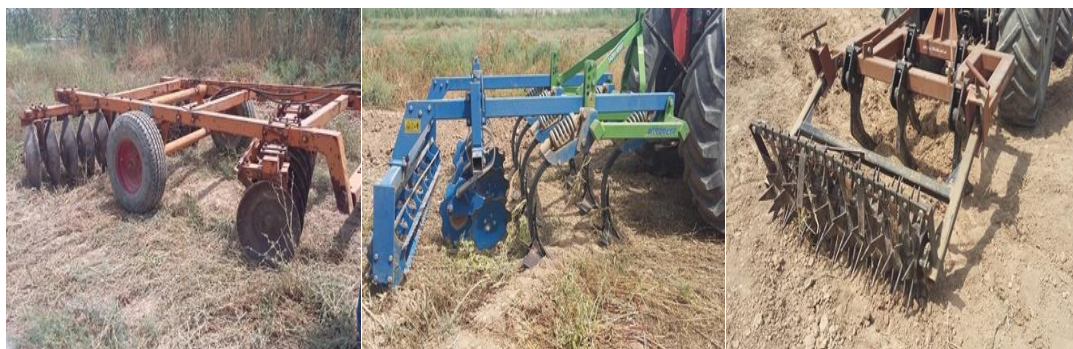
شکل ۱. ادوات خاکورز مورد آزمایش: گاواهن چیزل پکر سوار (سمت راست) خاکورز مرکب (وسط) و دیسک خارج از مرکز (سمت چپ)
