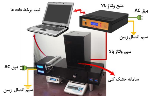
شکل ۱. طرحواره سامانه خشک‌کن توسعه داده شده
