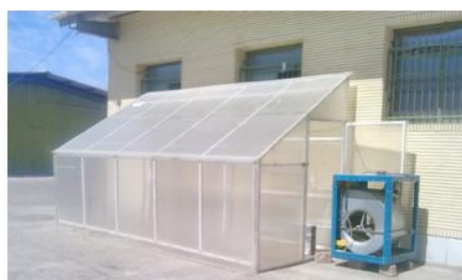
شکل ۱. الف) گلخانه با سامانه سرمایش تبخیری استفاده شده در تحقیق و ب) طرح‌واره‌ای از اجزای سامانه سرمایش تبخیری
