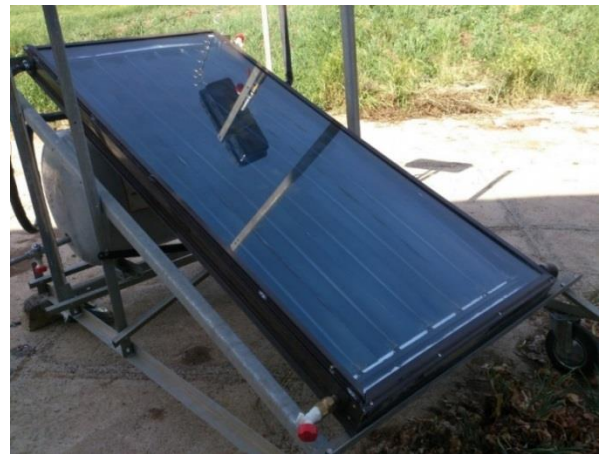
شکل ۱- نمایی از جمع کننده خورشیدی صفحه تخت مورد استفاده
