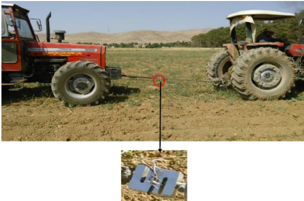
شکل ۴- نمایش آزمایش دو تراکتوری برای اندازه‌گیری مقاومت کششی.
