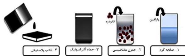
شکل ۲. مراحل آماده‌سازی PCM آمیخته شده با نانوذره
