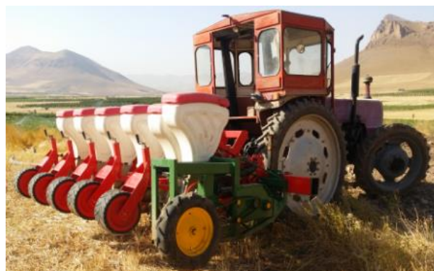
شکل ۱- الحاق کارنده پنوماتیک آفتاب‌گردان به کارنده چغندر قند جهت اجرای کشت مخلوط
