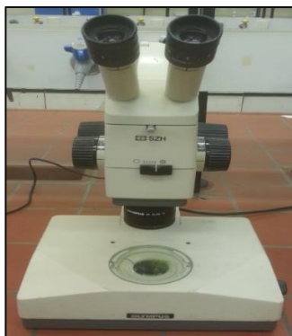
شکل ۱- دستگاه بینوکولار جهت شمارش آفات
