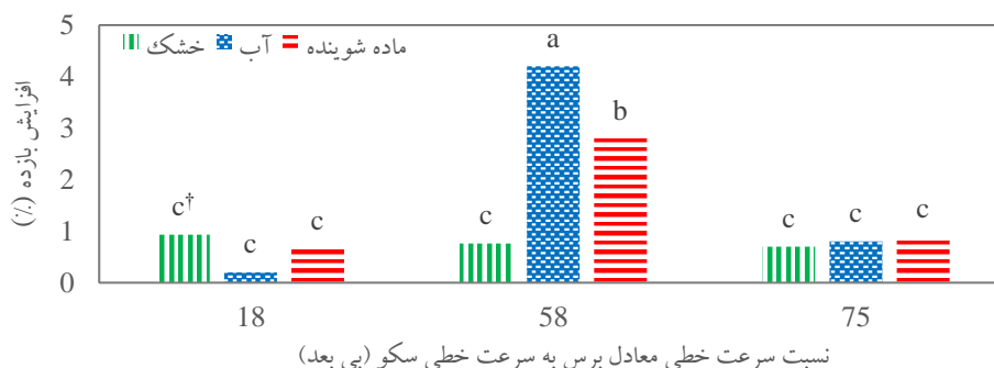
شکل ۸- بررسی اثر متقابل عامل‌های نسبت سرعت خطی معادل برس به سرعت خطی سکو و نوع ماده شوینده پنل بر روی افزایش بازده پنل † میانگین‌های با حروف متفاوت تفاوت معنی‌دار در سطح احتمال ۵ درصد را نشان می‌دهد.
