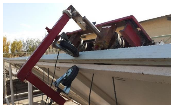
شکل ۴- جزئیات نحوه اتصال ماشین تمیزکننده به آرایه‌های فتولتائیک و سامانه حرکت ماشین بر روی آرایه‌ها
