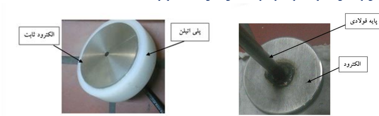
شکل ۱۱- تصاویر الکتروودهای متحرک و ثابت مورد استفاده در محفظه نمونه
