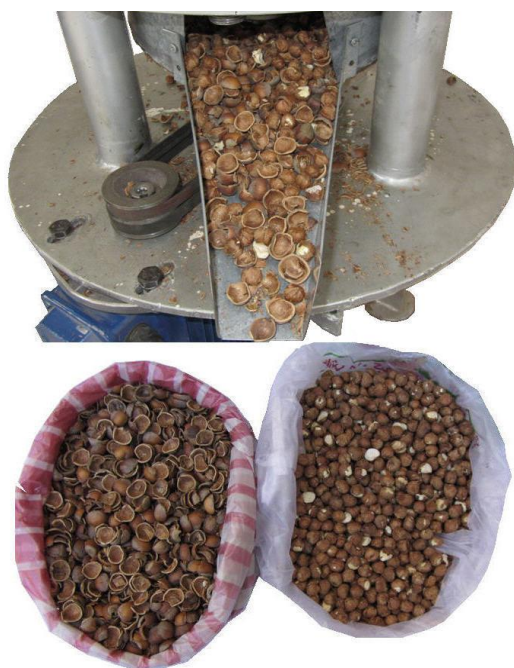
شکل ۴- خروجی فندق‌های شکسته شده و تفکیک مغز از پوست.
